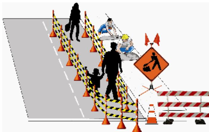
Cuando se adelanten labores de excavación en el frente de obra se debe aislar totalmente el área excavada (delimitar el área con cinta) y fijar avisos preventivos e informativos que indiquen la labor que se está realizando. Para excavaciones con profundidades mayores a 50 cm, la obra debe contar con señales nocturnas reflectantes o luminosas, tales como conos luminosos, flashes, licuadoras, flechas,
